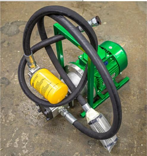
Станция оснащена двумя рукавами, для крепления которых на раме установлены проушины. Один из рукавов – всасывающий, он погружается в резервуар, откуда идет откачка рабочей жидкости. Второй рукав напорный, который подключается к резервуару, куда должна наполняться чистая жидкость. Насосный агрегат с фильтрами собраны на общей раме с удобной ручкой для переноски.
